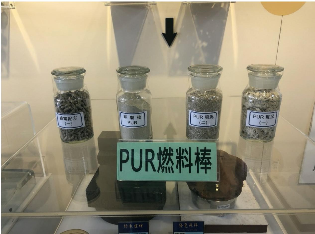
圖說：將電冰箱回收後，裡頭的隔熱泡綿經分選純化等處理後即可化身為燃料棒，有效降低焚化廠負擔。（圖／環保聯盟回收其簽名）
