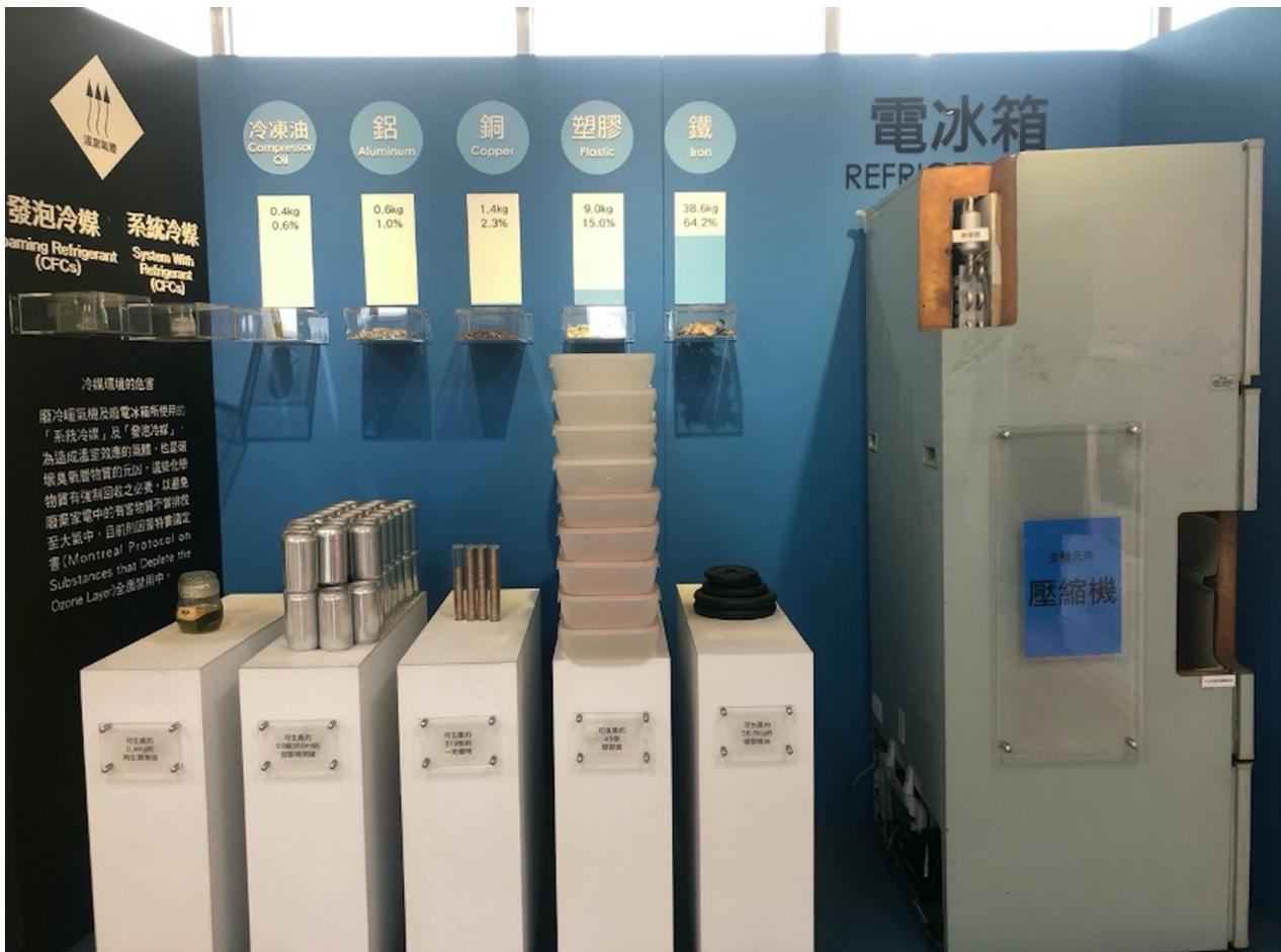
廢冰箱妥善回收後，可使用內部的隔熱泡棉製成燃料棒，賦予回收家電新的生命。（圖／環保署回收基金會）
